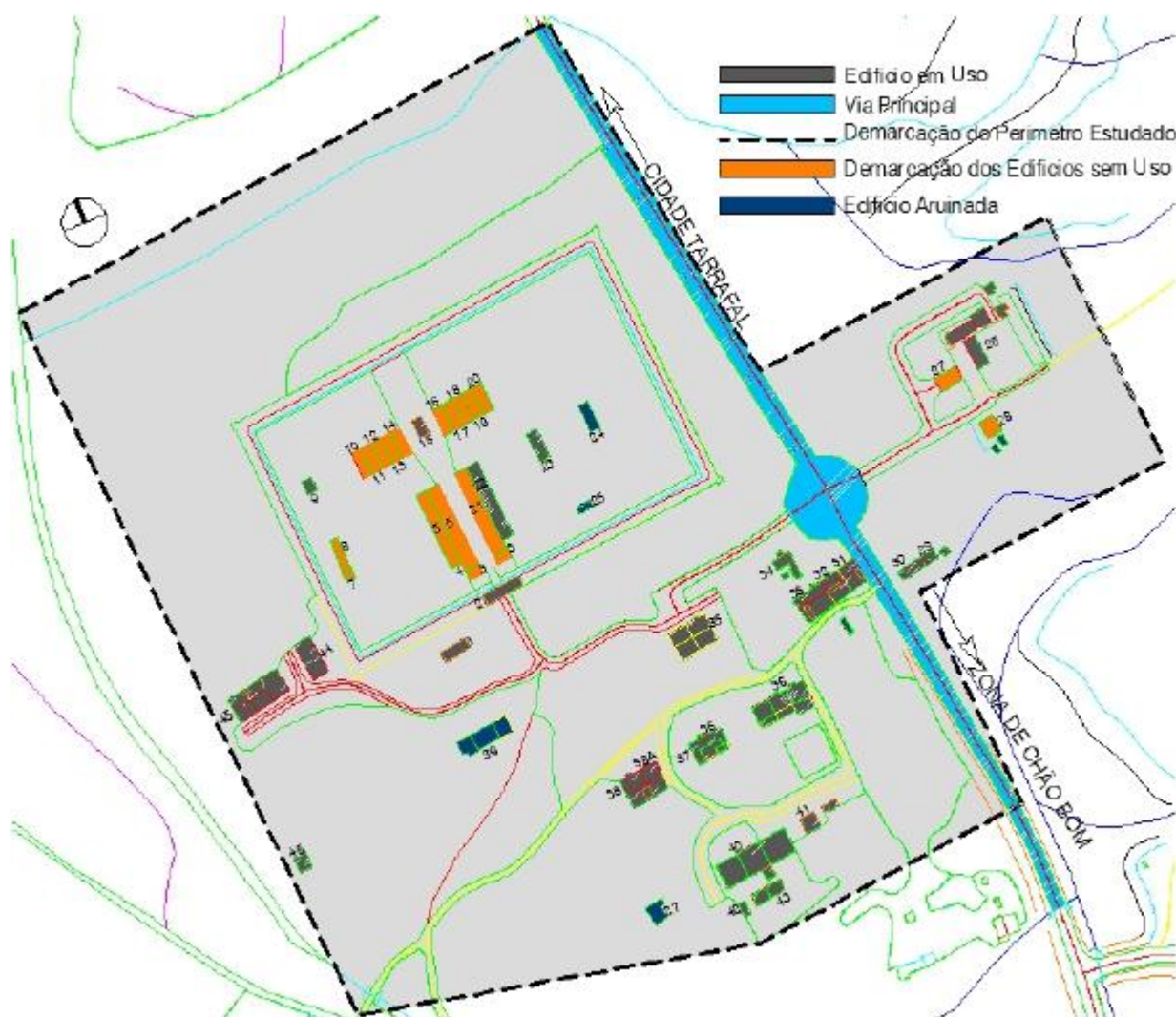
Figura 11: Mapa síntese do estado da conservação do Museu da Resistência; Fonte: Cortesia do arquiteto Luís Semedo
